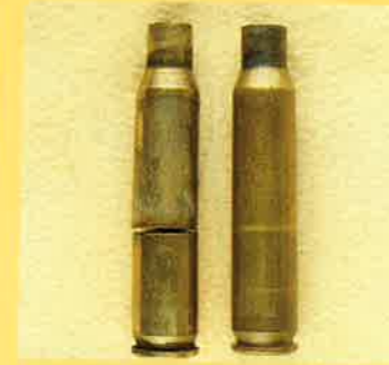
Där hylsväggen smalnat av och börjar bli ganska jämntjock är det vanligt att hylsan sträcker sig. Tittar man noga kan man se hur godset är tunnare just där. Ännu är det ingen fara för hylsseparatoring.
