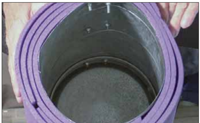
Uffes magnumrulle är tillverkat av ett spirorör med en fastskruvad botten.
