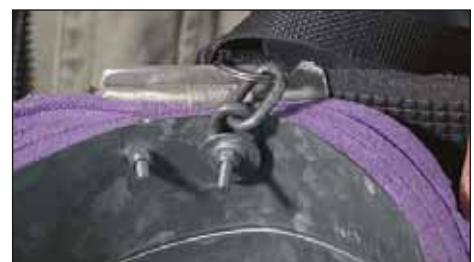
Liggunderlaget är fäst i rullen med hjälp av en aluminiumplåt med genomgående skruvar.
