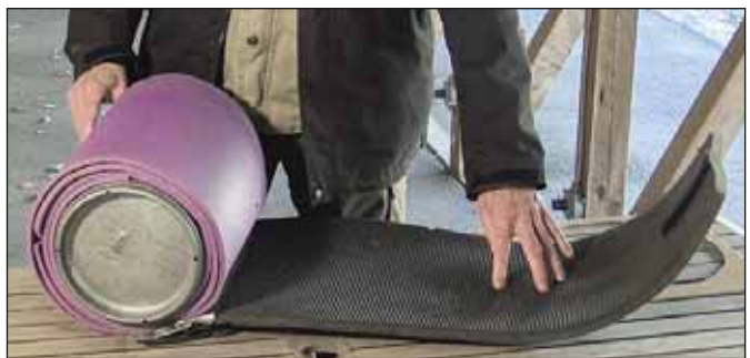
Liggunderlaget är fäst i rullen med hjälp av en aluminiumplåt med genomgående skruvar.
