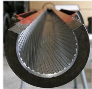
Figur 5 Räffling i pipa
