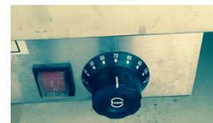
Strömbrytaren och termostaten
