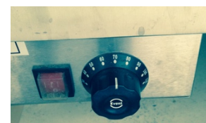
Strömbrytaren och termostaten
