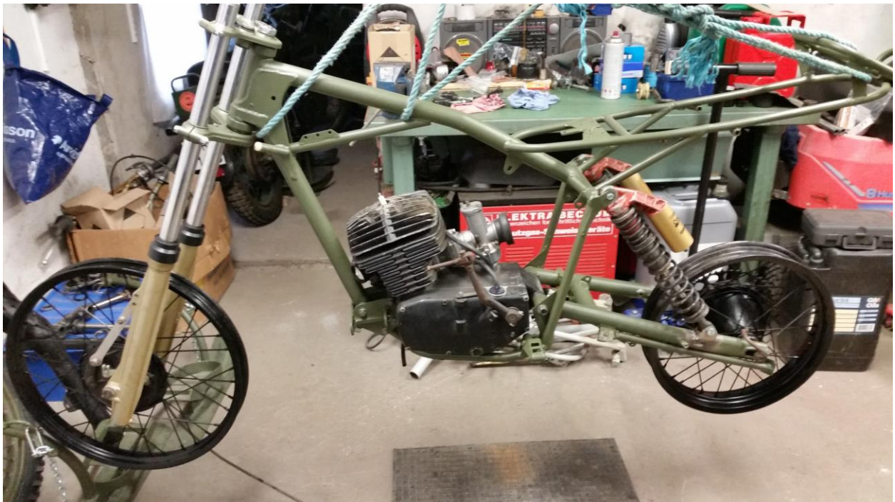
April 2016, projektet tog form, sprickorna i fälgarna fanns ej kvar, efter svetsning samt lackering. Fortfarande pågick jakten efter rätt stötdämpare.
