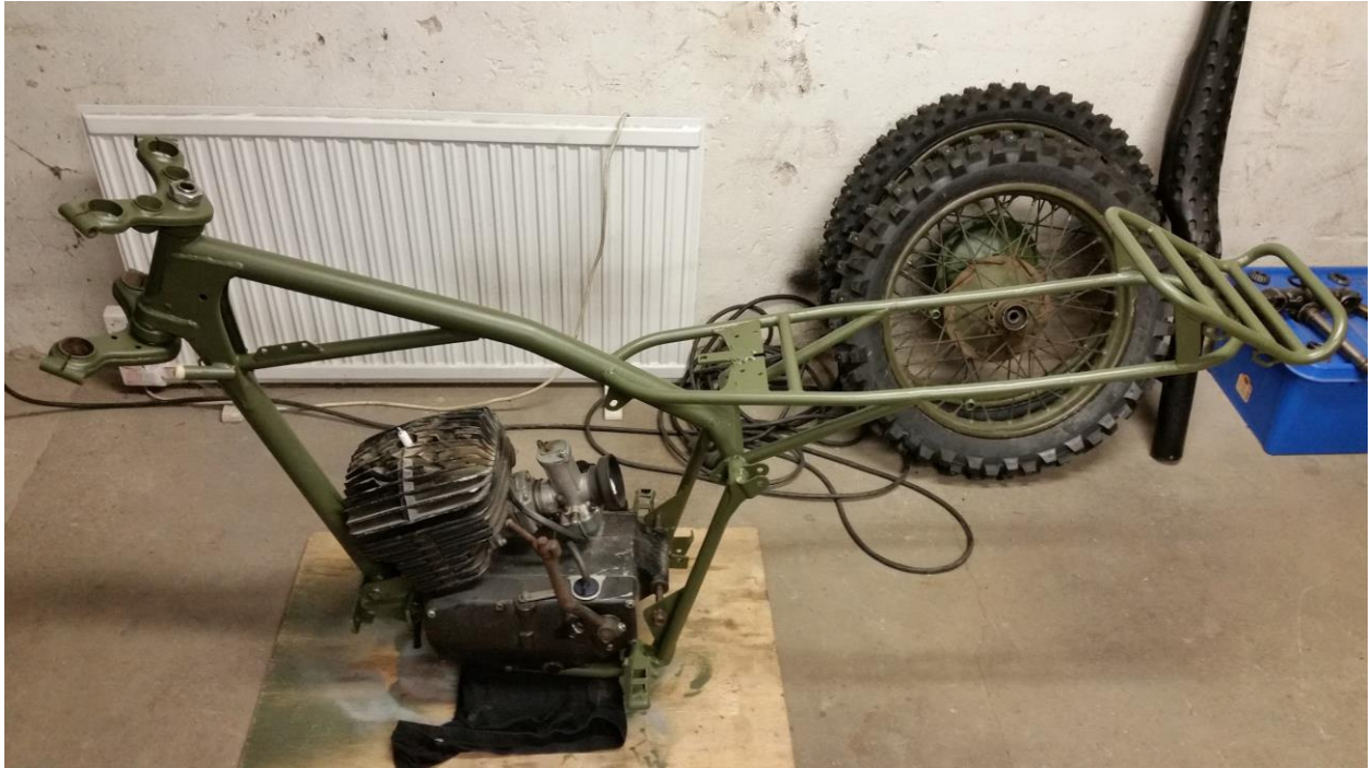
Februari 2016, Med svetsning klar och lackering utförd, provmonterades motorn för första gången, dock återstod mycket arbete.
