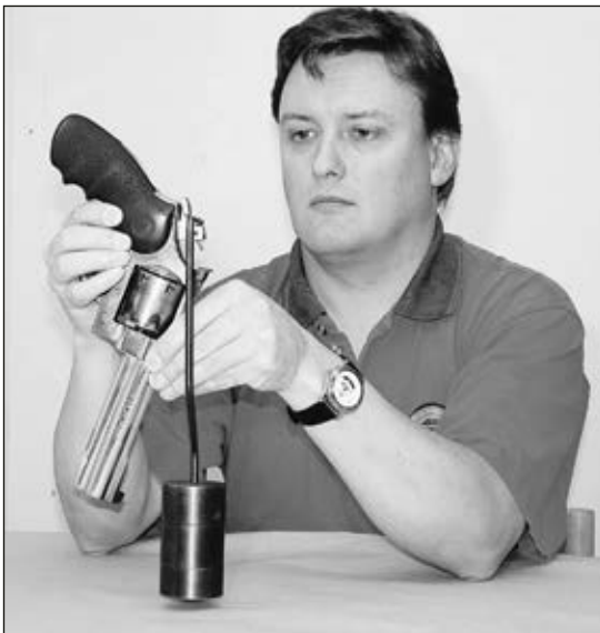
Bild 2: Kontroll av upphakningsmotstånd.
